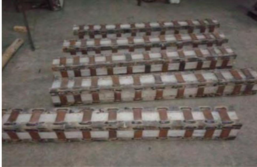
الشكل (3-3): شكل النماذج المدعمة بالهيكل الفولاذي وفق الدراسة المرجعية [8]
