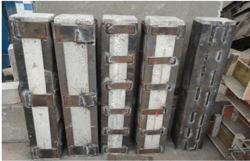
الشكل (27-2): أشكال تدعيم العينات بعد صبها وإجراء التدعيم [4]
