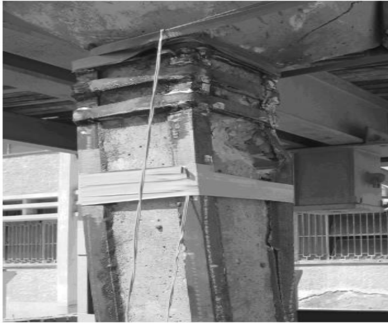
الشكل (2-8): شكل الانهيار للأعمدة المدعمة المزودة بمبسطات ذات توزيع غير منتظم [9]
