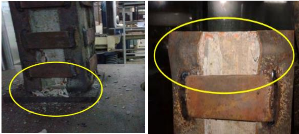
الشكل (28-3): التلدن في قمة وقاعدة الهيكل الفولاذي في النموذج التجريبي [8]
