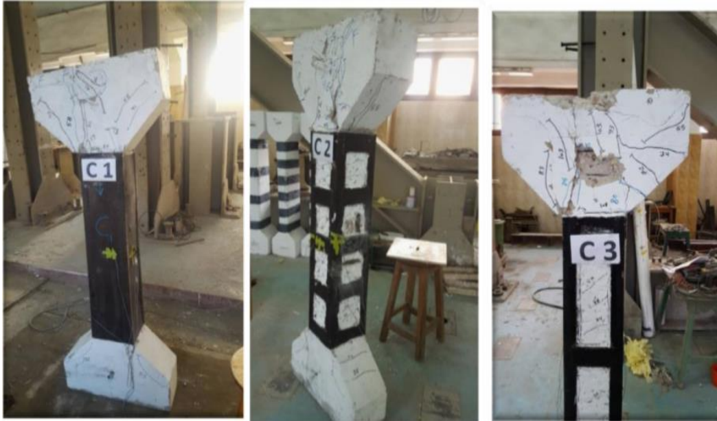
الشكل (24-2): أشكال التشققات الحاصلة في العينات المختبرة (C1)، (C2)، (C3) [3]
