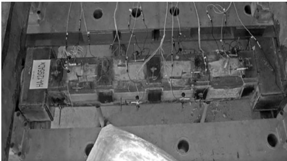
الشكل (20-2): العينة المختبرة من النوع (B) المزودة بتاج، حيث تدعيمها بعد رفع الحمولة النوع (D) [11]
