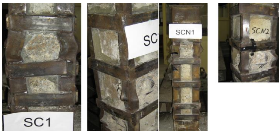
الشكل (12-2) أشكال الانهيار لعينات الأعمدة المدعمة [19]
