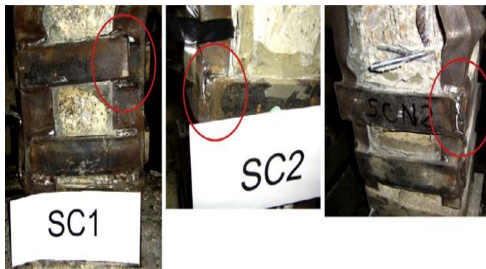
الشكل (13-2) انفصال اللحام بين المبسطات الأفقية والزوايا الشاقولية في بعض عينات الأعمدة المدعمة
