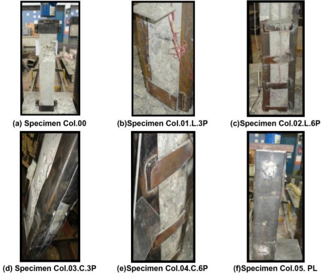
الشكل (28-2): أشكال الانهيار لعينات الأعمدة المختبرة [4]
