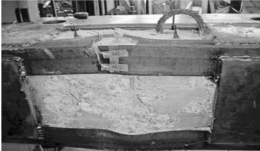
الشكل (22-2): الانهيار في العمود المدعم المختبر [11]
