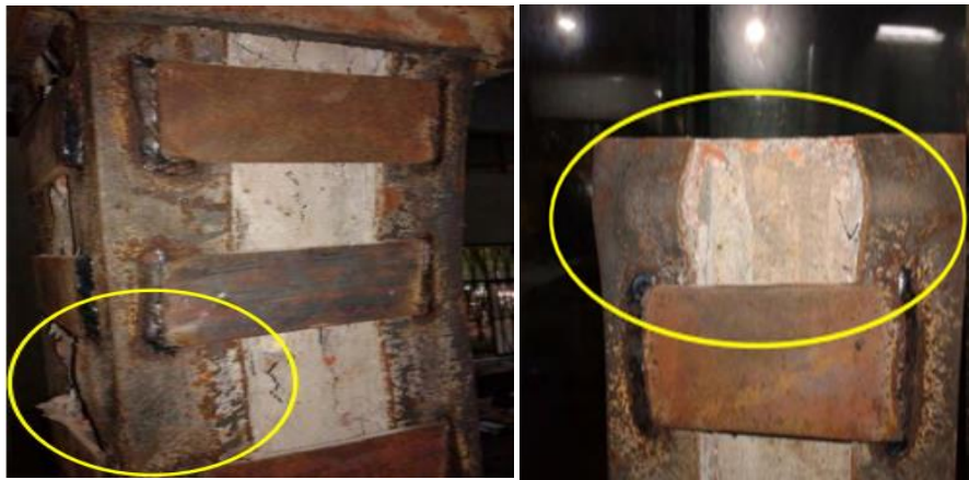
الشكل (31-3): التلدن ضمن زوايا الهيكل الفولاذي في النموذج التجريبي [8]
